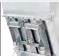
5. Schäffer-Hoflader mechanische Verriegelung Obere Einhängehöhe: 966 mm
