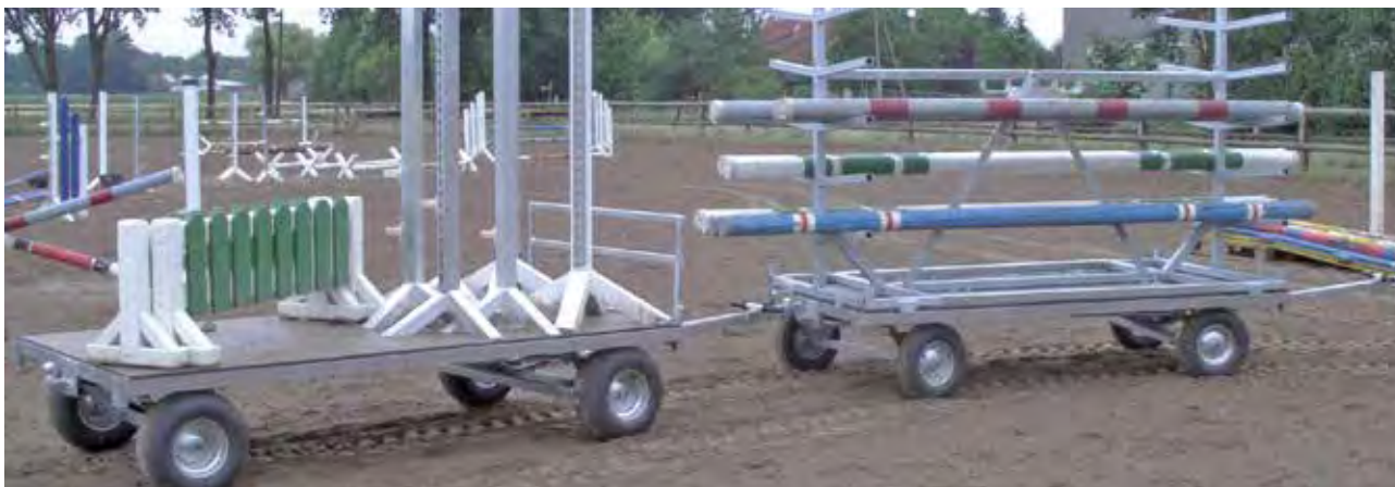
Wagen links: mit Breitbereifung, Kugelkopf und Kugelkupplung, Wagen rechts: mit Kugelkopf und Transportgestell in Sonderbauweise
