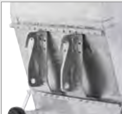
3. Weidemann hydraulische Verriegelung Obere Einhängehöhe: 915 mm
